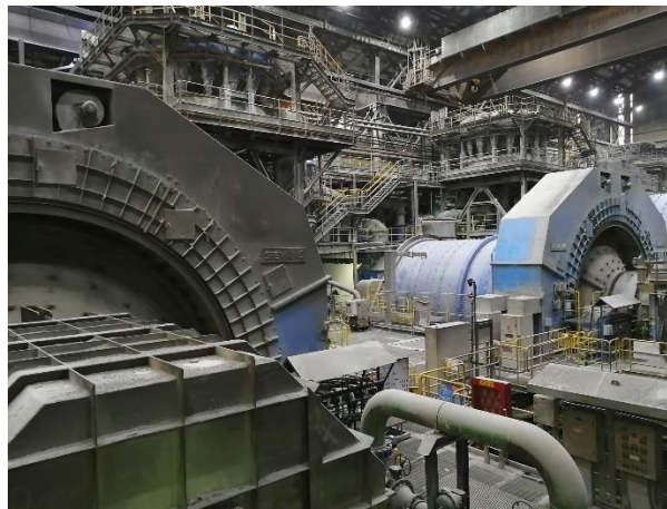
Figura 8. Molinos de bolas en Proceso SAG en Codelco División el Teniente.
