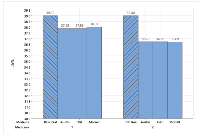
Figura 27. Estimación de nivel de bolas con diferentes modelos del molino de bolas 411.
