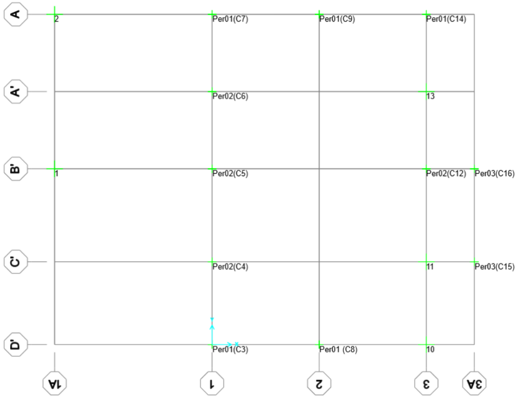
Figura 6.1 Discretización pernos de anclaje en bases de columnas arriostradas.
