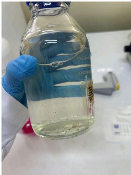
Figura 5. Efluente de aguas servidas domiciliarias posterior al autoclave Fuente: Captura propia
