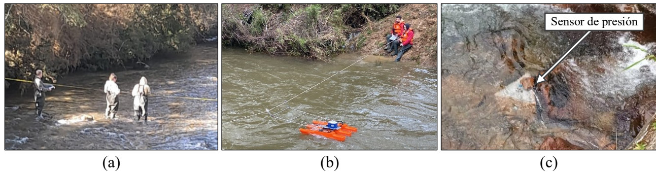
Figura 3.3 Aforo de caudal usando correntómetro (a) y ADCP (b). Instalación de sensor de presión atmosférica (c)
