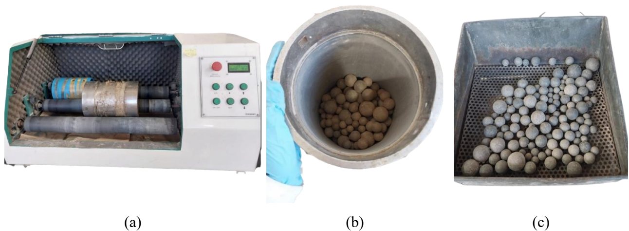
Figura 30. Proceso de molienda en molino de bolas: (a) Vista del equipo; (b) Interior con distribución de las bolas de acero; (c) Separación del material molido de los cuerpos moledores.
