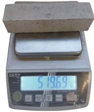
Figura 40. Proceso posterior al curado. (a) Secado de las muestras; (b) Horno de secado Labtech Hebro; (c) Pesaje de las muestras; (d) Dimensionamiento de las muestras.
