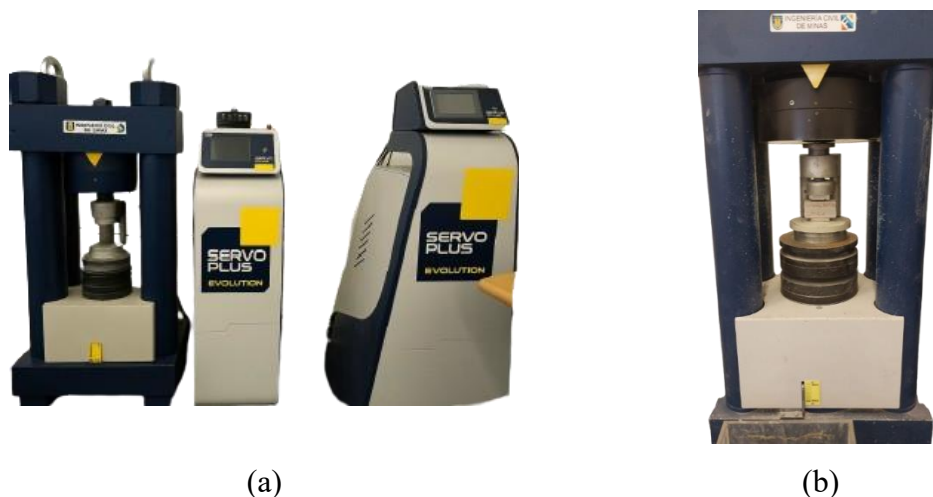
Figura 42. Ensayo de resistencia a la compresión. (a) Equipo MATEST modelo C088-11N; (b) Ejecución del ensayo.
