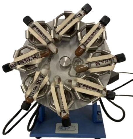
Figura 54. Muestras destinadas para análisis químico en periodo de agitación.
