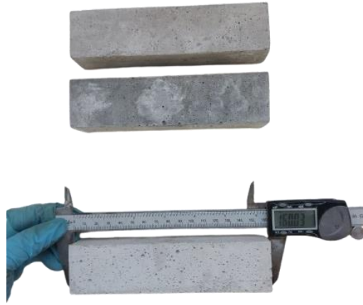
Figura 40. Proceso posterior al curado. (a) Secado de las muestras; (b) Horno de secado Labtech Hebro; (c) Pesaje de las muestras; (d) Dimensionamiento de las muestras.
