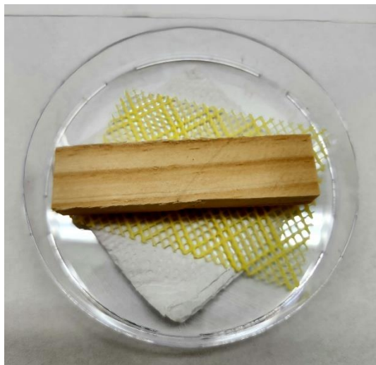
Figura 2. Cámara húmeda para las probetas de madera de Pinus radiata previo a la aplicación de solución con pigmentos e inoculación con Trichoderma viride .
