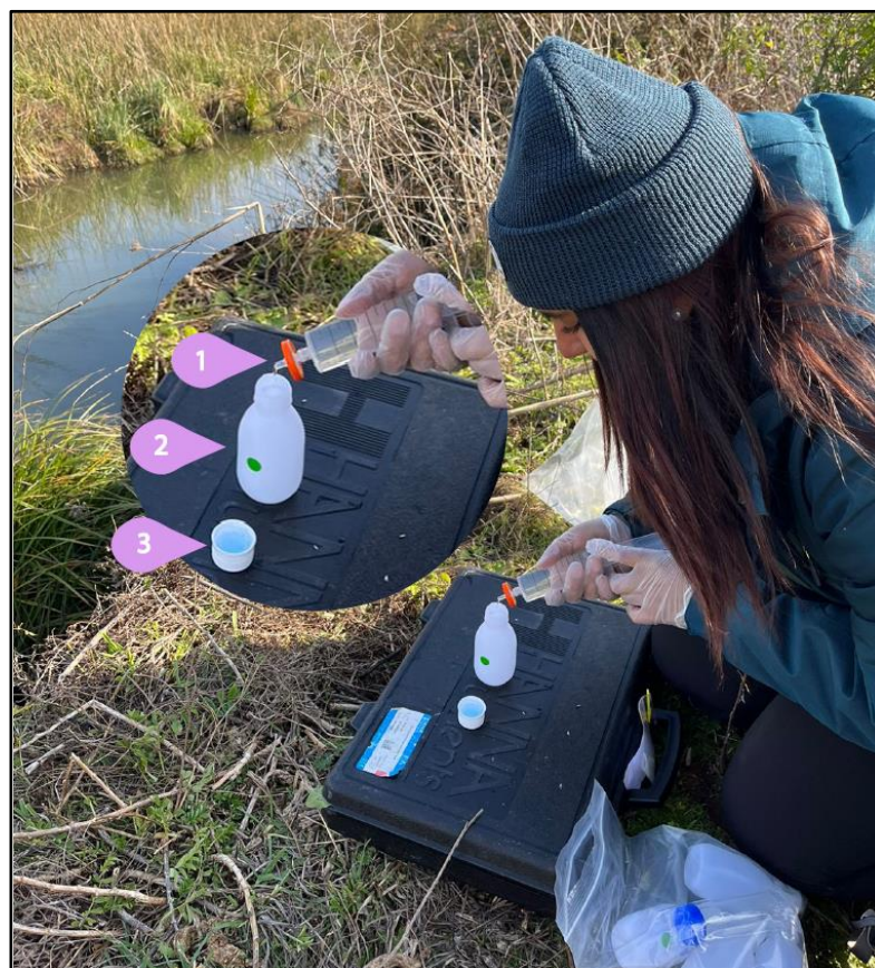
Figura 12: Procedimiento de filtrado de muestra. 1) Filtro microporo 0,22 \mu\text{m} y jeringa luer lock. 2) Botella de polietileno HDPE. 3) Tapa y contratapa.
