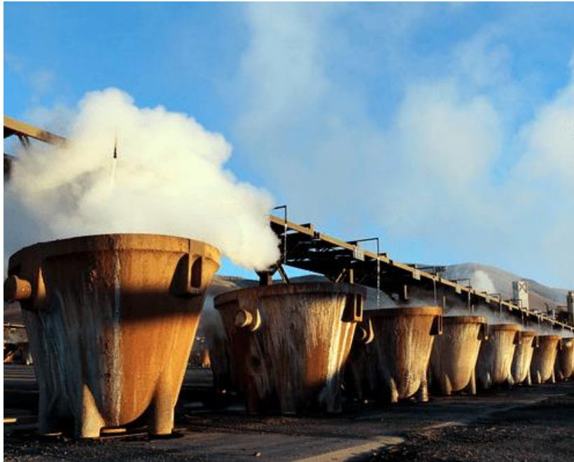
Figura 2. Sistema de regadío continuo en el parque de enfriamiento en tazas [12].
