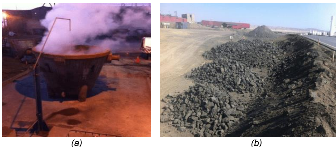
Figura 4. Enfriamiento de escorias en Altonorte. (a) Pruebas de enfriamiento preliminares en Altonorte. (b) Resultado por lotes de enfriamiento de escoria en tazas [8].
