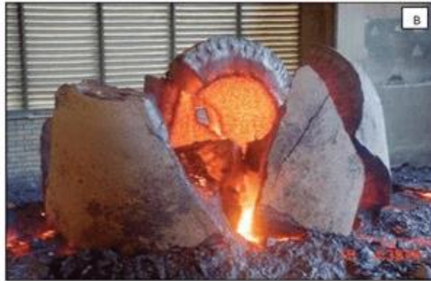
Figura 12. Imagen de un bloque de escoria parcialmente solidificado en taza [24].
