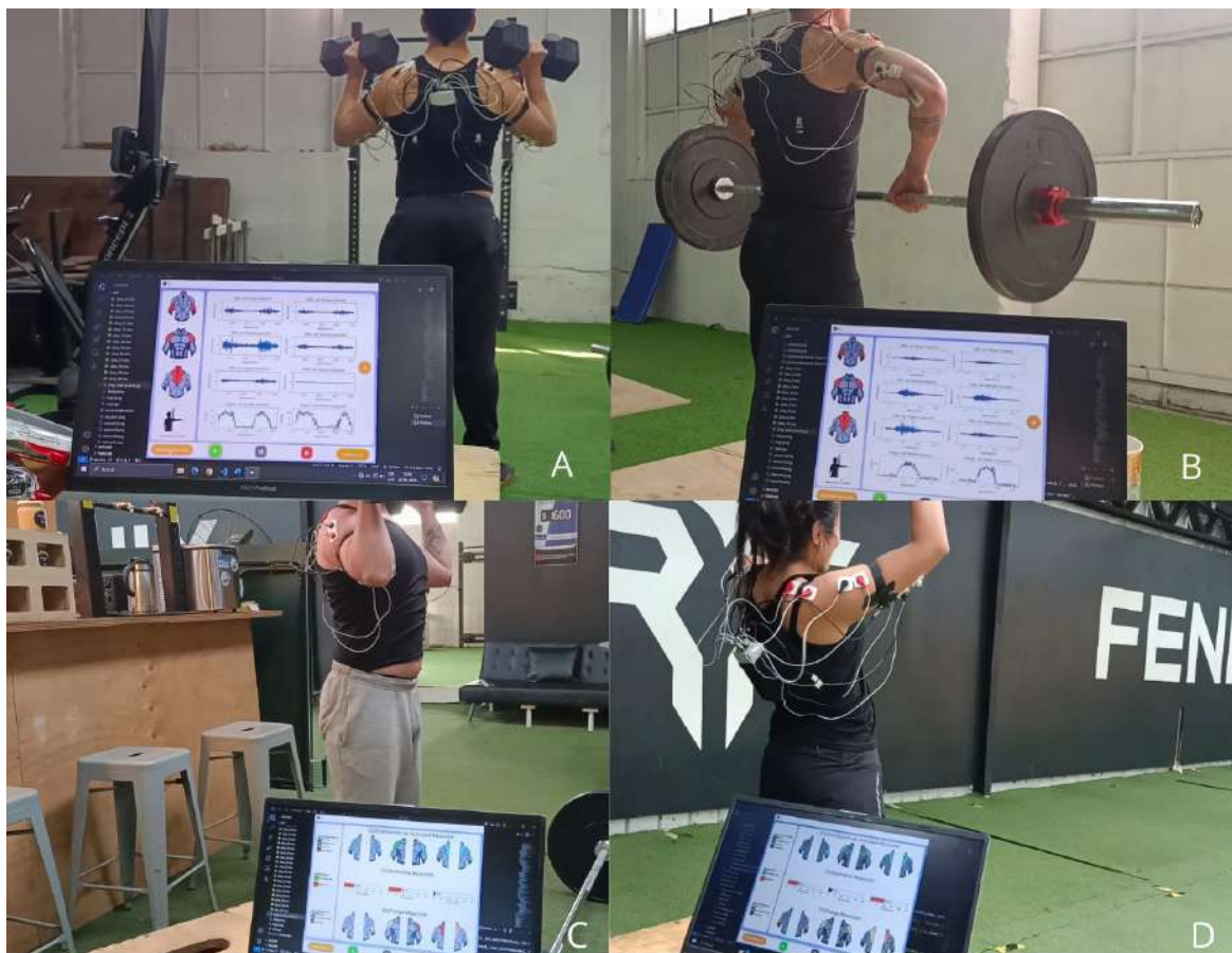
Figura 7.4: Sujetos junto al sistema de adquisición y visualización puestos a prueba. Imagen A.- Ejecución de press militar con el sistema de adquisición y la aplicación. Imagen B.- Ejecución de remo con barra junto al sistema. Imagen C y D.- Indicadores de fatiga, porcentaje de contracción y asimetría funcionando en tiempo real durante press militar.
