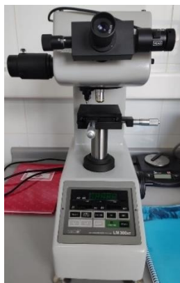
Figura 21. Microdurómetro utilizado para perfil de dureza ( HV_{0.01} \rightarrow HV_1 ).
