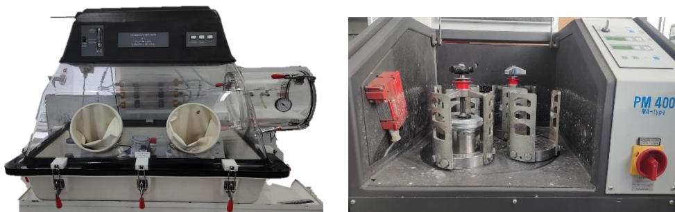
Figura 12. A) Cámara de guantes PLAS LABS modelo 850-NB/EXP. B) Molino planetario rápido modelo PM 400.
