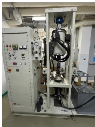
Figura 16. Horno prensado en caliente (HP-20, Thermal Technology Systems, USA)
