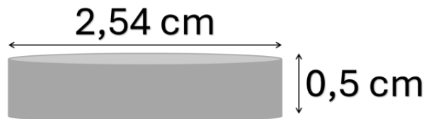
Figura 13. Dimensiones de probeta cilíndricas; elaborado por el autor
