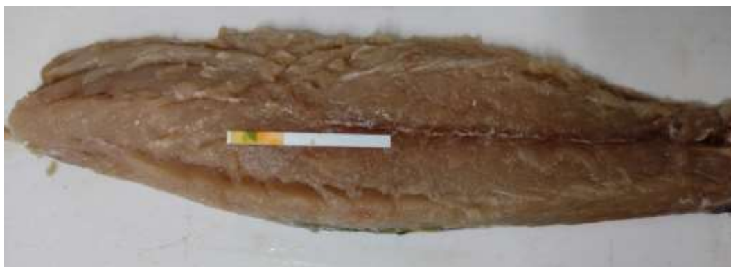
Figura 32. Medición correcta de pH en el filete.
