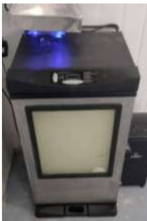
Figura 8. Cámara del equipo ahumador llena de humo producido por el generador de humo aledaño a éste.
