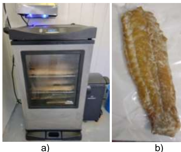
Figura 12. Vistas del proceso de ahumado caliente en filetes de lisa ( Mugil cephalus ), etapa de cocción-secado. a) Etapa final del ahumado, producto secándose a temperatura de 80°C, b) Producto termina,
