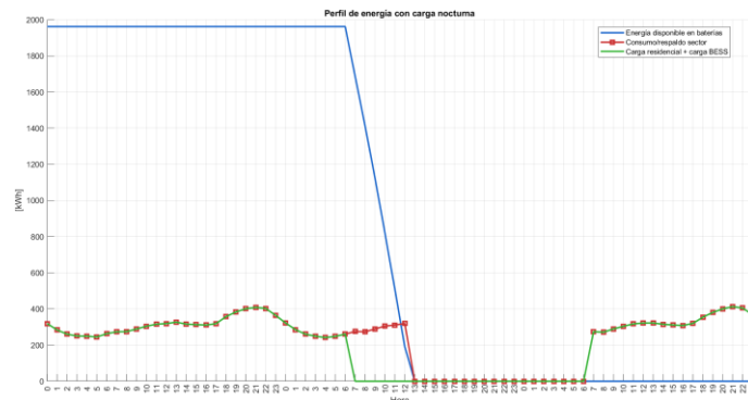
Figura G.3 Escenario 1: Comportamiento de BESS carga nocturna
