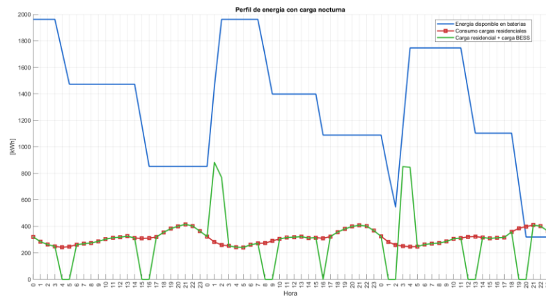
Figura G.6 Escenario 2: Comportamiento de BESS carga nocturna
