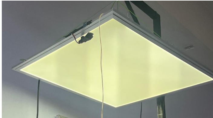
Fig. 18: Prototipo 2 panel LED 60 x 60 cm. Elaboración propia.
