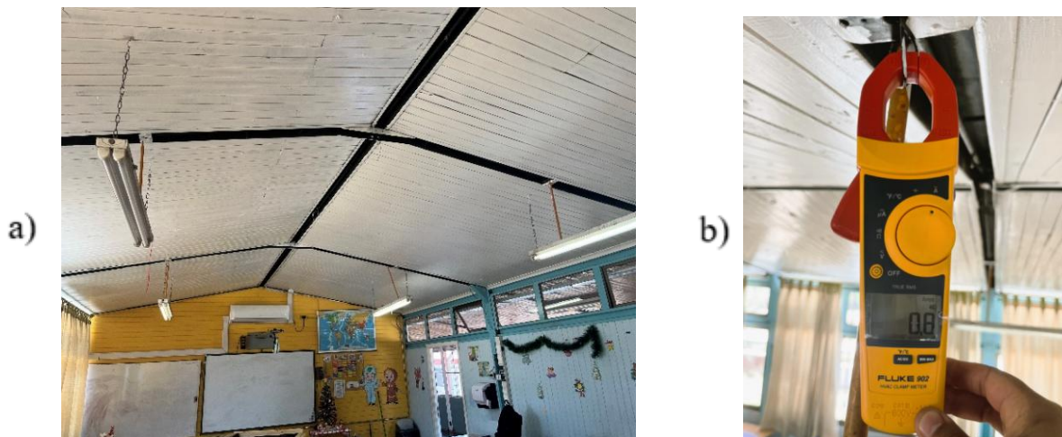
Fig. 11: a) sistema de iluminación fluorescente b) consumo de una luminaria completa. Elaboración propia
