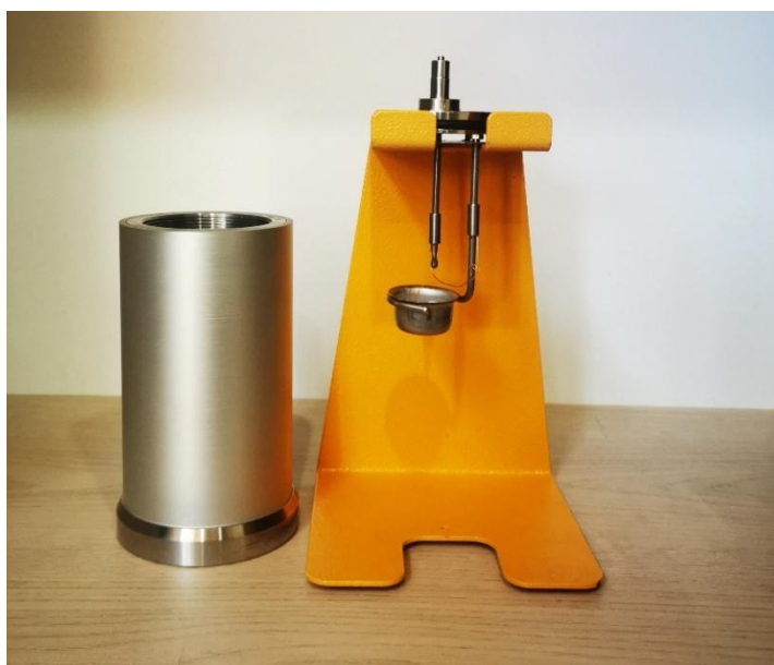
Figura 8: Componentes internos del tubo de combustión y disposición del crisol en el calorímetro.
