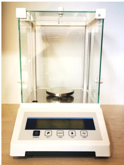
Figura 7: Balanza de precisión utilizada para el pesaje de las muestras antes del ensayo calorimétrico.
