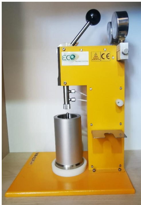
Figura 6: Sistema de suministro y conexión de oxígeno al calorímetro CAL2K ECO.
