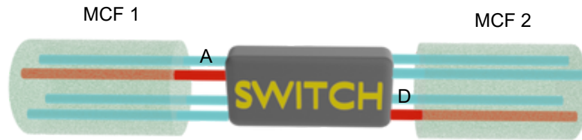
Fig. 1.1: Concepto de conmutación entre 2 fibras multinúcleo.
