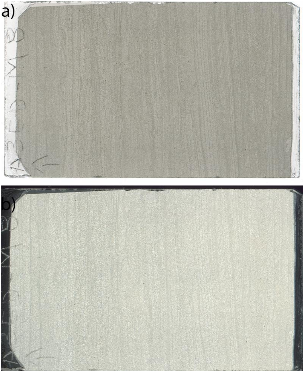
Figura 9.7: Escáner corte petrográfico A3ED-M8. a) Imagen en luz polarizada plana. b) Imagen en nicoles cruzados
