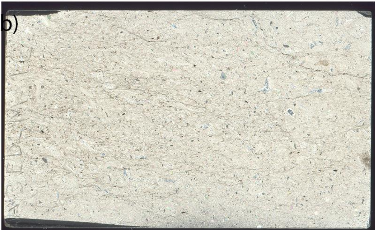
Figura 9.10: Escáner corte petrográfico A3ED-M12. a) Imagen en luz polarizada plana. b) Imagen en nicols cruzados
