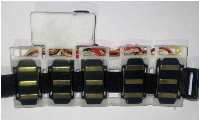
Figura 3.4: Vista inferior del diseño impreso en 3D. Se observan los cinco sensores EMG adheridos mediante una correa, y el cableado interno entre los módulos.
