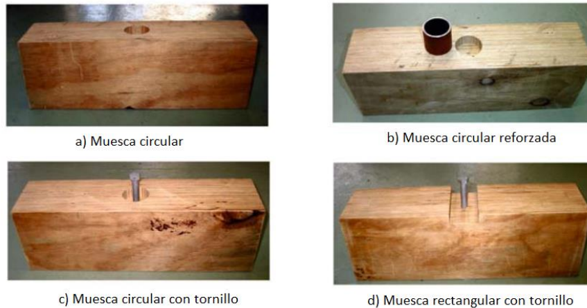
Figura 2.4 Ejemplos de sistemas de conexión de muescas (Deam et al., 2008).
