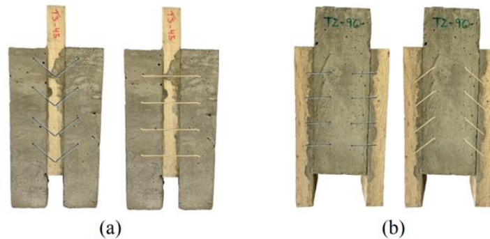
Figura 3.2 Probetas: (a) HMH en -45° y 90°; (b) MHM en 90° y 45°
