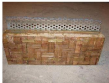
a) Placa perforada pegada con adhesivo epoxi a la madera
