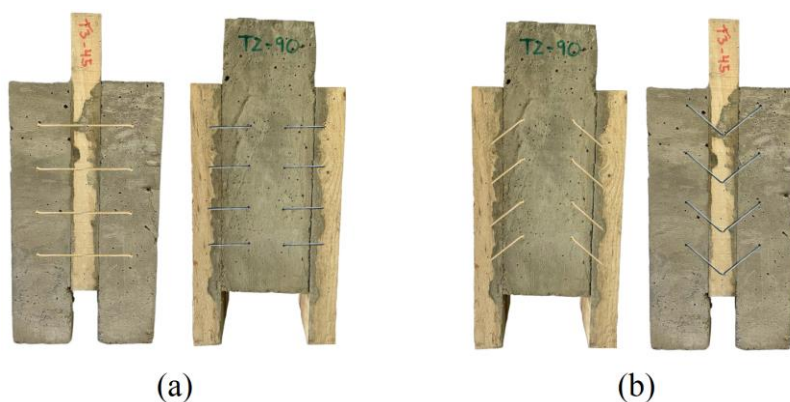
Figura 3.11 Ejemplo de ángulos de conexión de los especímenes para MHM y HMH: (a) Conector en 90°; (b) Conector en 45° (MHM) y -45° (HMH)
