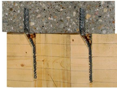
Figura 2.11 Falla: Deslizamiento relativo del conector con aplastamiento en madera (Dias et al., 2018)
