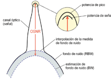
Fig. 3.2: Representación gráfica de una señal en un espectro óptico. Fuente: [7]
