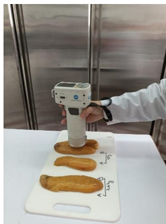
Figura 5. Determinación de gónadas frescas para obtener el L*, a, b de la muestra, con colorímetro Chroma Meter, CR-400.
