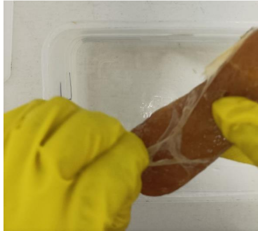
Figura 17. Proceso de retiro de la membrana externa de la botarga, la membrana se humedece con agua para esta ser retirada sin dañar el producto, luego es enviada a la estufa de secado.
