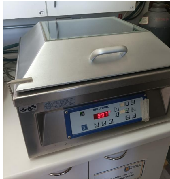
Figura 38. Equipo Multivac C200 para envasar botarga en bolsas de vacío de 0,18 milímetros de grosor.
