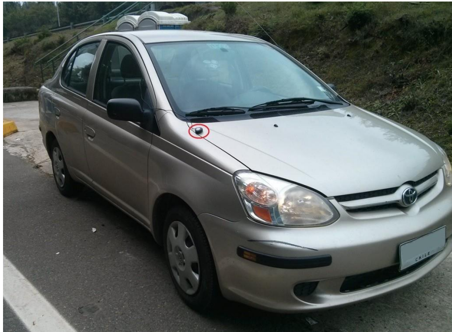
Figura A.4.3.6 Ubicación de la antena del GPS
