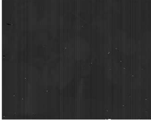
Figura 3.3: FPN presente en una cámara Xeva 320 SWIR. Notar como líneas verticales de intensidad aumentada plagan la imagen. Cada sensor y banda poseen un ruido característico distinto a los demás, por lo que no existe una solución única a este fenómeno.
