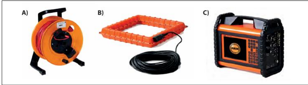
Figura 4.2: Elementos del equipo WalkTEM de ABEM. A) Cable de 160 m para el loop transmisor de 40 x40. B) Antena receptora de 0,5 x 0,5 m 2 . C) Consola de adquisición de datos (Extraído de Blanco, 2016).
