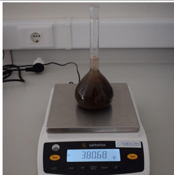
Fotografía 7.4 Determinación de la masa final de la suspensión, a volumen conocido.
