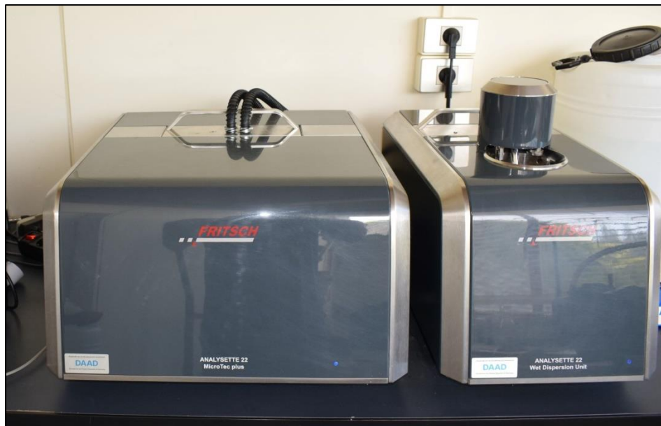
Fotografía 4.1 Equipo ANALYSETTE 22 MicroTec Plus del Instituto GEA. Unidad Lectora a la izquierda y Unidad Dispersante a la derecha de la imagen.
