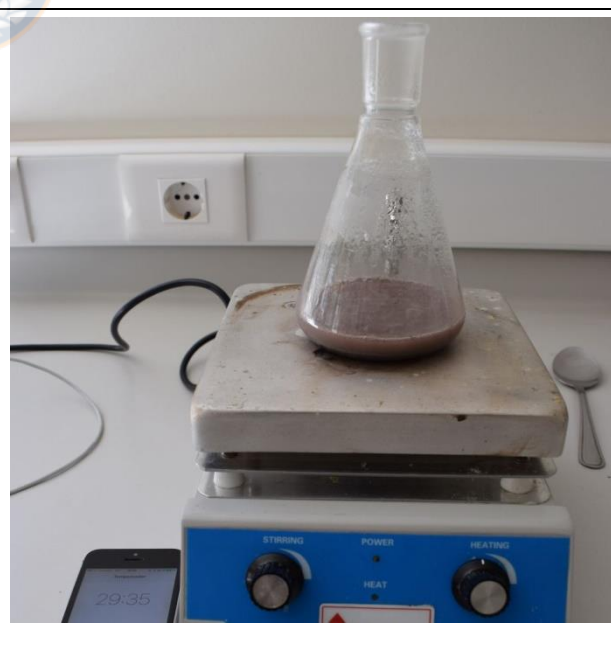
Fotografía 7.2 Eliminación de moléculas de aire de la suspensión aplicando calor.
