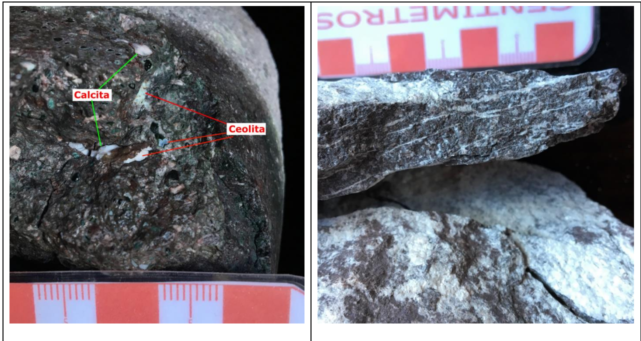
Fotografía 2.3 Relleno de vesículas y cavidades en andesita, con material ceolítico y calcita.
