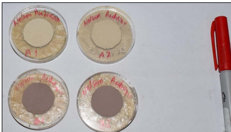
Fotografía 5.1 Pulverizado de roca en disco para portamuestras del equipo de difracción de rayos x.
