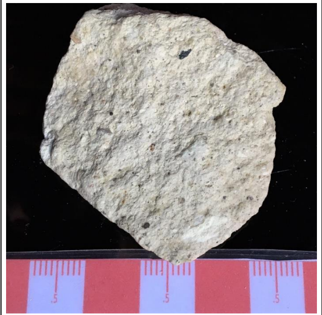
Fotografía 2.6 Muestra de toba vítrea con alto contenido de vidrio y baja presencia de líticos y cristales (FC3). Escala en cm.
