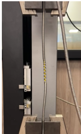
Fig. 3.23: Chaqueta de fiber-optic bundle traccionada.
