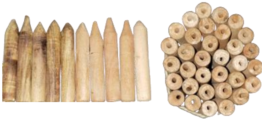
Figura 2. Tarugos con su forma y perforación lista para la inserción del microchip.
