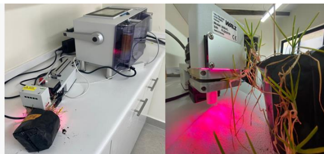
Figura 1. Medición de intercambio de gases utilizando WALZ GFS-3000 equipado con cubeta LFC.
