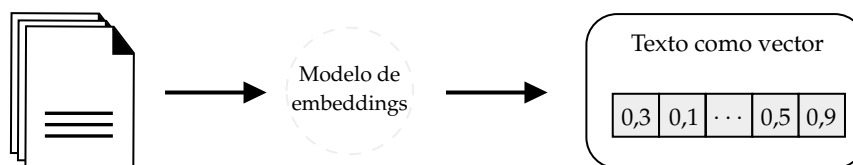
FIGURA 3.1: Representación esquemática del proceso de obtención de embeddings a partir de texto mediante un modelo de lenguaje preentrenado.
