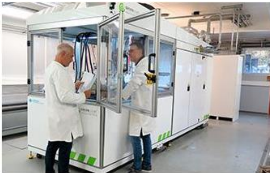
Figura 7.2. Banco de pruebas de celdas PEMFC de la empresa CEA Liten
