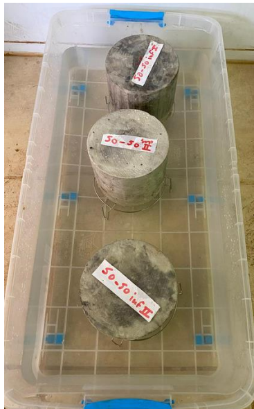
Figura 3.5 Montaje de ensayo de absorción capilar
