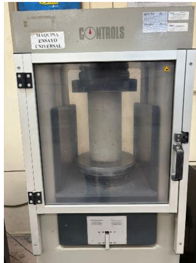
Figura 3.4 Ensayo a compresión en probetas cilíndricas de hormigón
