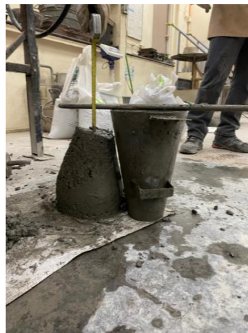
Figura 3.3 Ejecución del ensayo del cono de Abrams
