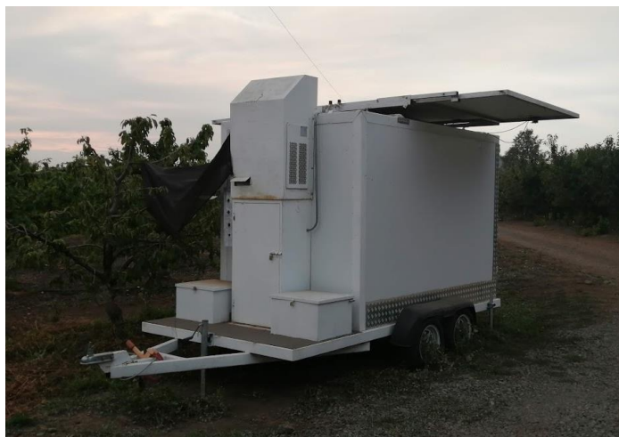
Figura 6. Cámara de frío fotovoltaica utilizada para almacenar y conservar Cerezas en XVI Región de Ñuble, Comuna de Coihueco.
