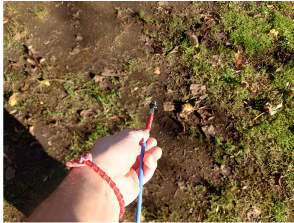
Figura 3.4: Medición de Irradiancia de Suelos desnudos. Fuente elaboración propia.
