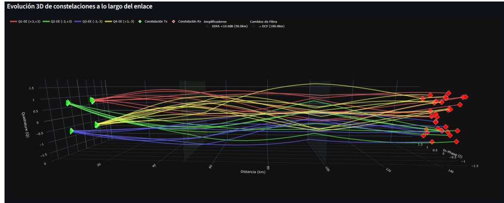
Fig. 3.16: Gráfico 3D interactivo de evolución de constelaciones en la GUI. Los ejes I y Q representan las componentes en fase y cuadratura, mientras que el eje inferior nos muestra la distancia en km del enlace final. Los colores indican regiones de la constelación según modulación. Esta visualización revela cómo la señal se degrada progresivamente debido a dispersión y no linealidad. Dentro del legend vemos Q1, Q2, Q3 y Q4 que representan los cuatro cuadrantes del plano complejo en el caso de una modulación QPSK, las constelaciones al momento de TX (en verde) y RX (en rojo). Finalmente nos muestra información del enlace como la posición de cada bloque EDFA y cada vez cambio de fibra (con otros parámetros) identificando si esta es DCF o no.
