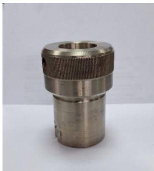
Figura N°4.1: Reactor de acero inoxidable recubierto con teflón.
