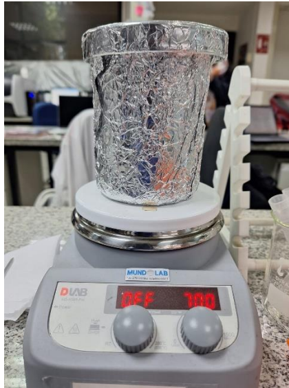
Figura N°1.4: Sistema de adsorción en oscuridad de fenol.
