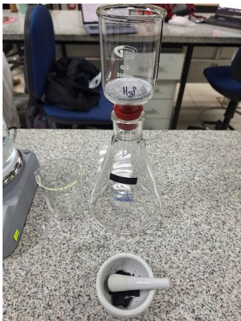
Figura N°I.2: Equipo de lavado de carbón activado.
