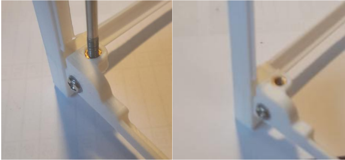
Figura 57: Aplicación exitosa de insertos roscados en la estructura del CubeSat.
