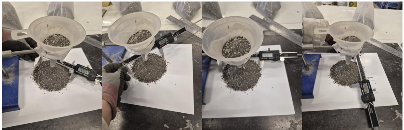
Figura 11. Mediciones del cono en cuatro direcciones distintas
