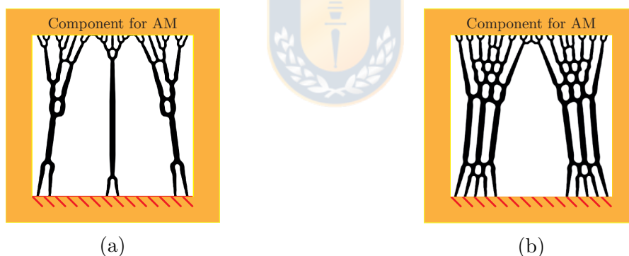
Figura 5.15: En a) soporte interno generado con la restricción de mínima separación entre miembros con una fracción final de volumen del 16.68%. En b) soporte interno generado con la restricción de mínima separación entre miembros con una fracción final de volumen del 26.04%
