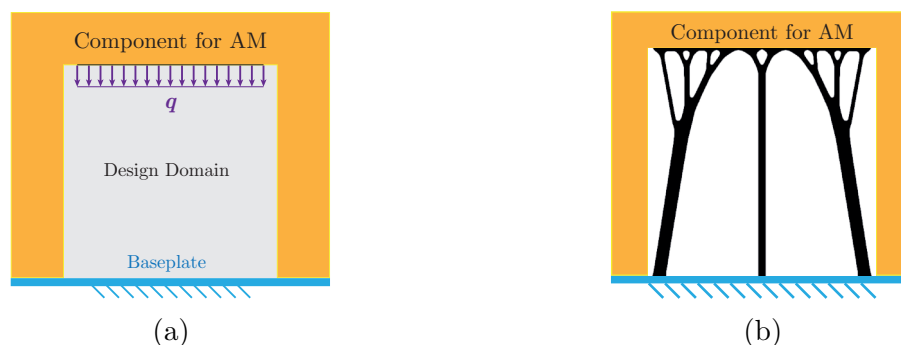
Figura 5.7: En a) formulación para crear espacio entre los troncos y las ramas con la pieza a imprimir. En b) resultado obtenido con el nuevo modelo.
