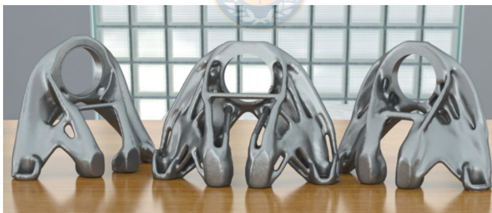
Figura 1.4: Optimización topológica con control de escala de longitud de estructuras de anclaje para un estanque de combustible de un avión. Imagen obtenida de [Eduardo Fernández, 2020].
