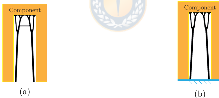
Figura 5.5: En a) soporte generado sin restricción de ángulo sobresaliente. En b) soporte generado con restricción de ángulo sobresaliente.
