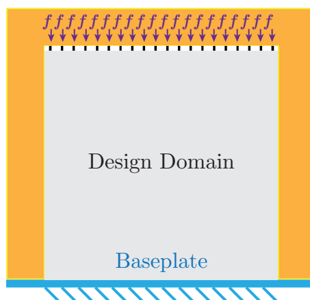
Figura 5.12: Formulación del problema de optimización donde las fuerzas se aplican de forma puntual.
