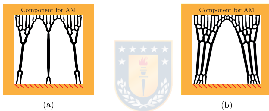
Figura 5.16: En a) soporte interno generado utilizando fuerzas puntuales con una fracción final de volumen del 17.62%. En b) soporte interno generado utilizando fuerzas puntuales con una fracción final de volumen del 26.45%.
