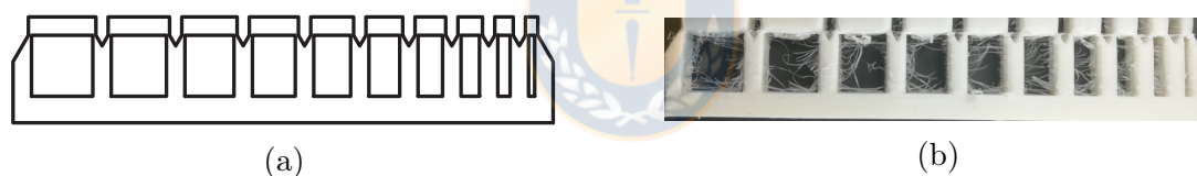
Figura 4.9: En (a) esquema de la pieza a imprimir para determinar la máxima distancia entre apoyos simples. En (b) foto de la geometría fabricada por la impresora Ultimaker.
