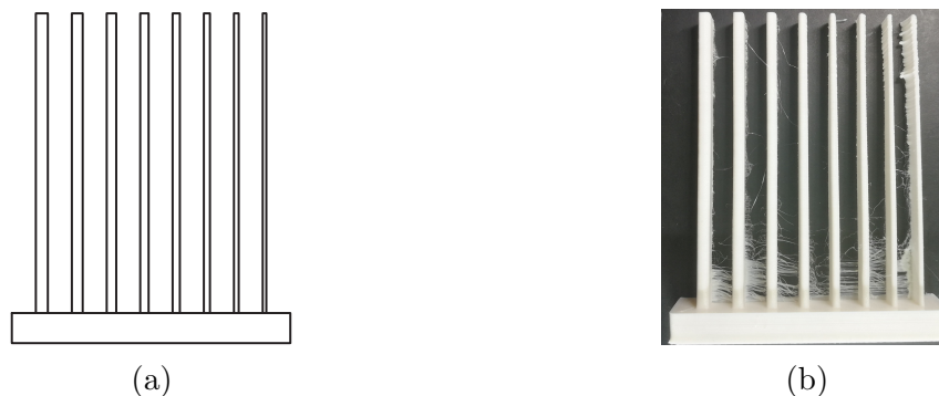
Figura 4.5: En (a) esquema de la pieza a imprimir para determinar la máxima relación de aspecto. En (b) foto de la geometría fabricada por la impresora Ultimaker.
