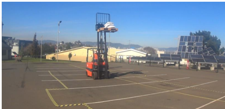
Fig. 9 Escenario 1, correspondiente a banco de ensayo en un evento de riesgo (mover en cargas de gran altura con carga desequilibrada).
