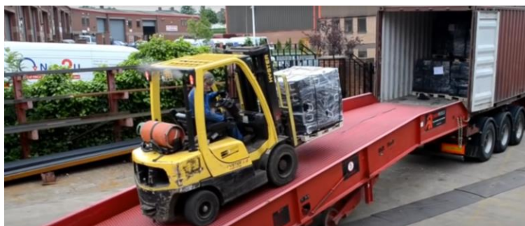
Fig. 14 Escenario 6, realizando un evento de riesgo (conducir en pendientes con una inclinación superior a 15°)
