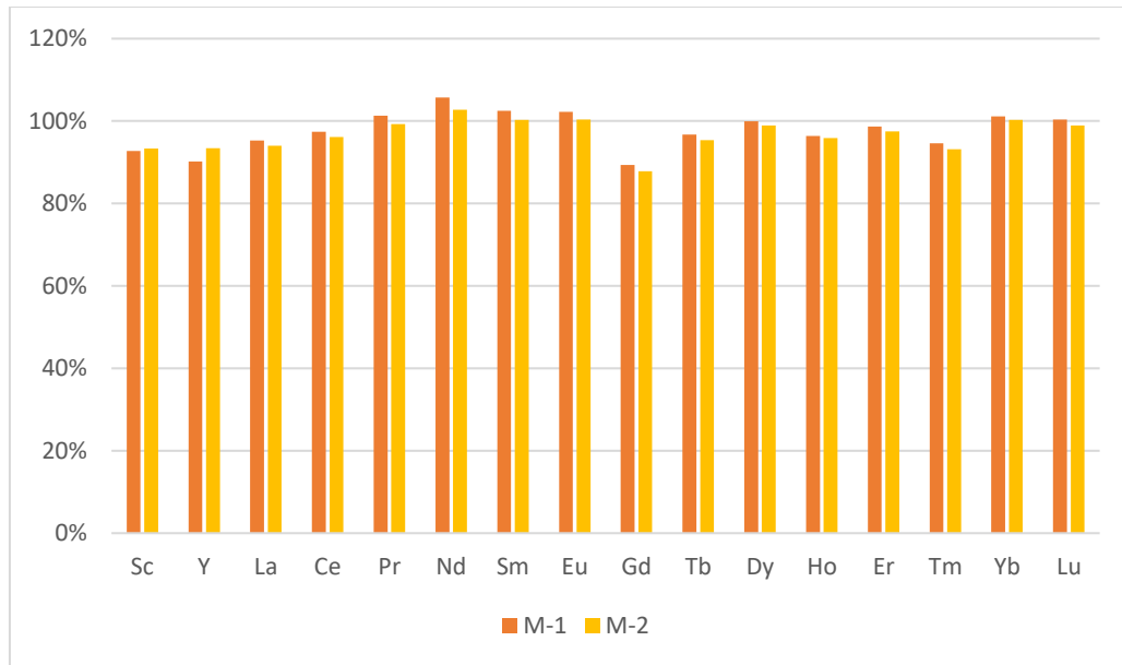
Figura 24. Comparación en eficacia de lixiviación de REE en las muestras 1 y 2 obtenidos a razón líquido sólido igual a 10 (M-1 con 25% exceso HCl y M-2 con 5% exceso HCl).
