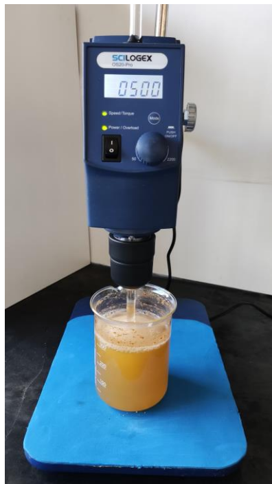
Figura 10. Montaje pruebas de lixiviación de carbonatos con agitación.
