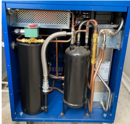
Figura 3.14: Componentes del compresor ARS.
