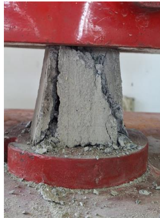
Figura 11. Mortero seco posterior a la compresión.
