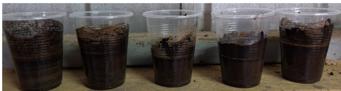
Figura 3. Mezcla fresca de mortero, borra de café y agua destilada.
