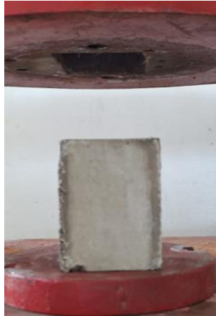
Figura 10. Mortero seco momentos antes de ensayo de compresión.
