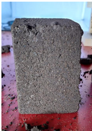
Figura 12. Mortero con adición de borra de café, secado de 7 días.
