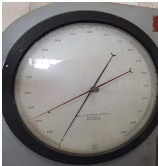
Figura 8. Parte donde se mide en libras la fuerza de compresión de la máquina de ensayos universales.
