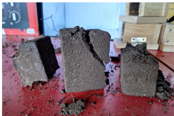
Figura 18. Molde agrietado de mortero con borra de café, secado de 7 días.
