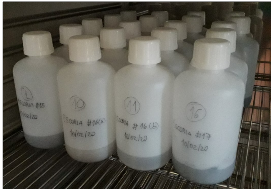
Figura 4.7: Botellas del experimento en estufa a 40°C. Se puede observar desde arriba hacia abajo en rotulado: Número correlativo de botella, muestra de polvo de escoria respectiva y fecha de muestreo.
