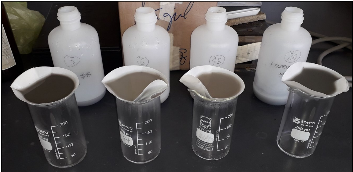
Figura 5.1: Separación del contenido de botellas con experimento. El polvo de escoria queda retenido en el cono formado por el papel filtro, mientras que el líquido es retenido en el vaso de precipitado respectivo. Fotografía de última recolección de muestras realizada (14 de julio de 2020).
