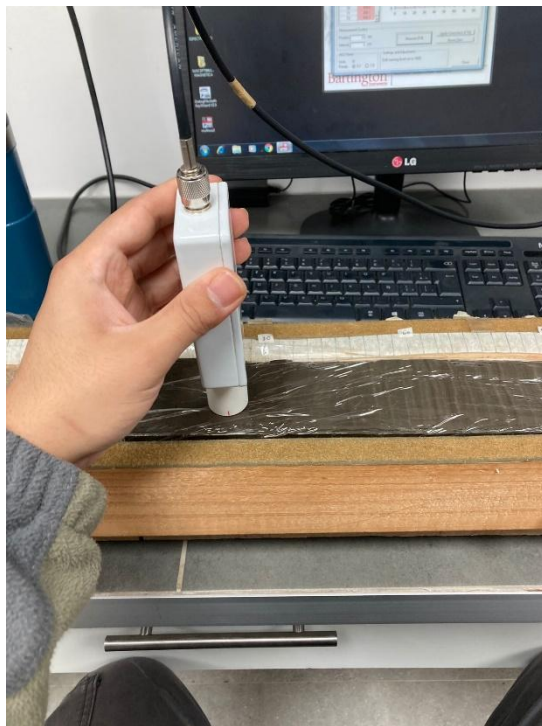
Figura N°11: Medición Continua de Susceptibilidad Magnética.
