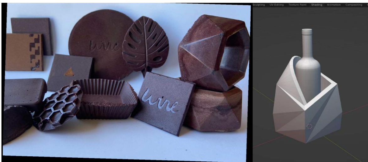
Figura 4. Materiales biodegradables y prototipo de Contenedor aislante de vinos hecho a partir de orujos de uva.
