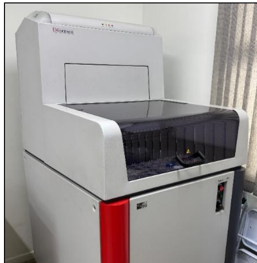
Figura 5. Equipo de difracción de rayos X. Marca Bruker D4 Endeavor utilizado para el análisis mineralógico de las muestras.
