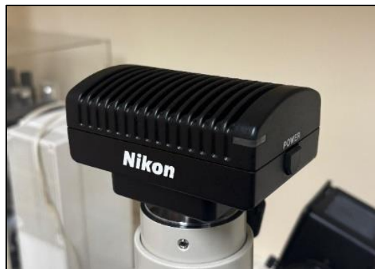
Figura 4. Cámara digital NIKON modelo DS-Fi3 acoplada al microscopio.
