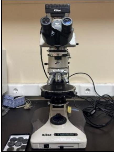
Figura 3. Microscopio óptico para petrografía NIKON OPTIPHOT 2-POL.
