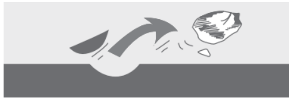
Figura 7.10 Ejemplo de abrasión en la pared de la tubería [29].
