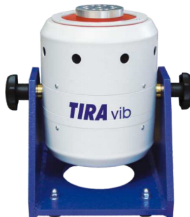
Figura 3.19 Shaker electromecánico TIRA TV 51110 utilizado para la excitación vibratoria.
