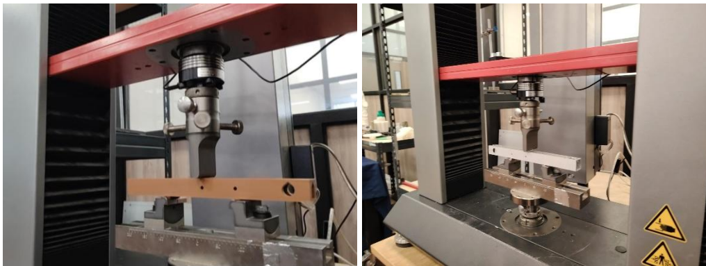
Figura 40. Brazo de PLA y aluminio bajo ensayo de flexión de 3 puntos.
