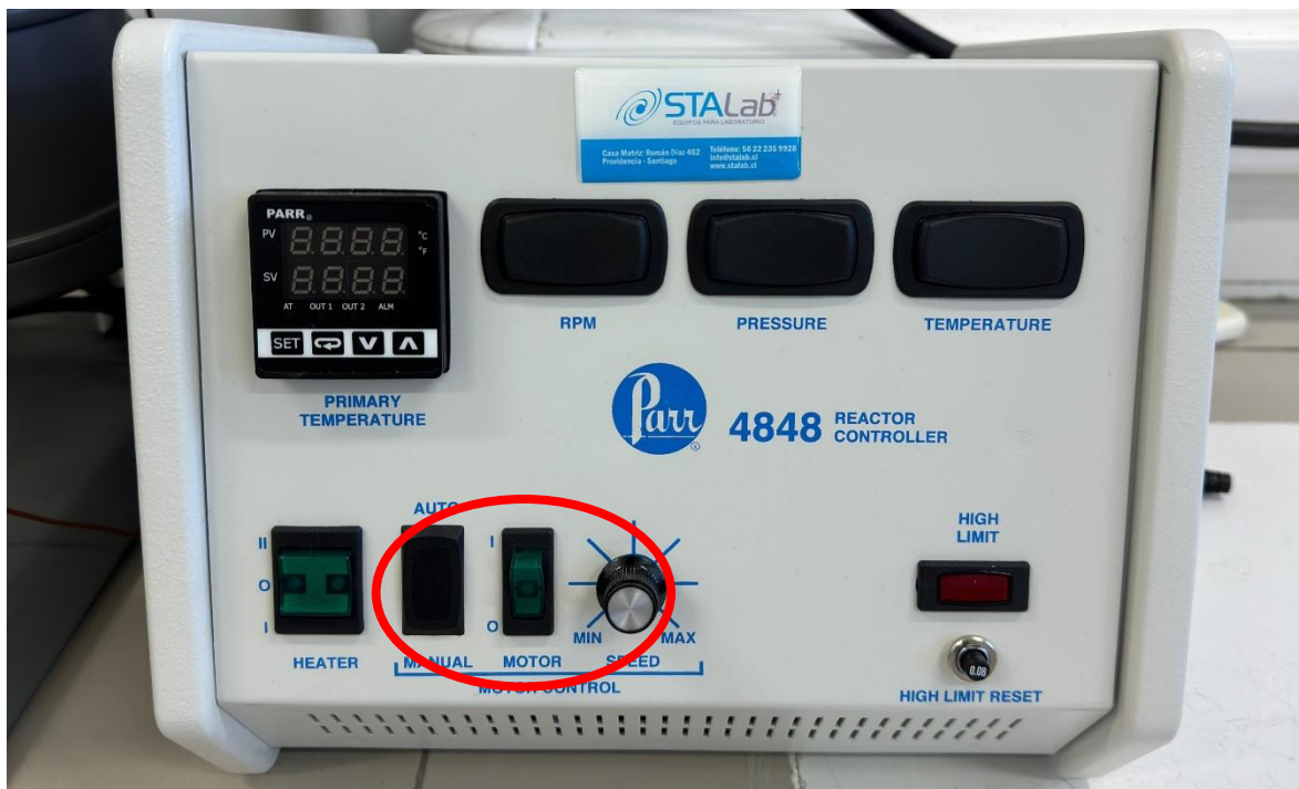
Figura 7.17. 4 Controlador del reactor Parr
