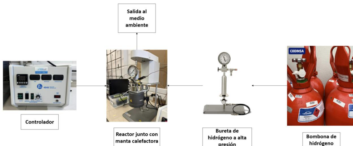
Figura 3.2. 1 Diagrama esquematizado del sistema de reacción para la hidrogenación de 9-etilcarbazol.
