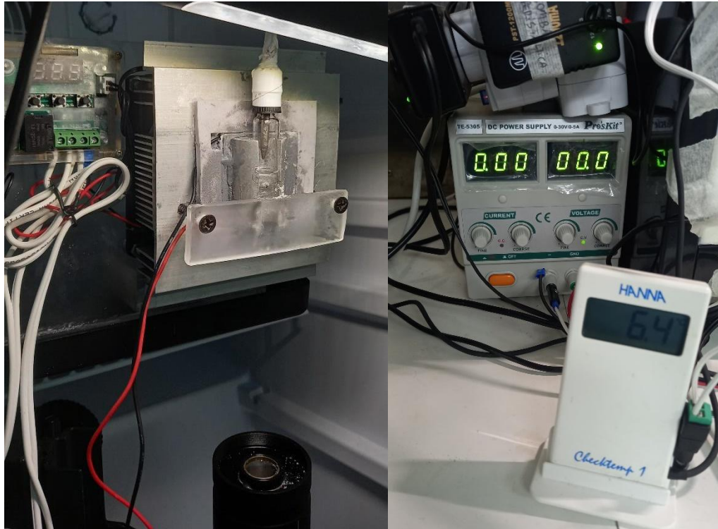
Figura 3. Sistema de medición de límites críticos térmicos.
